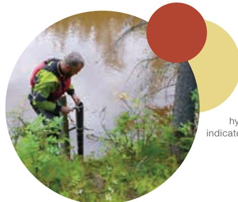
Un technicien en hydrologie installe un indicateur de niveau d'eau
